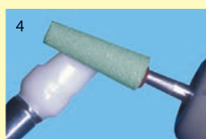
4 Odpowiednia gradacja ziaren diamentowych szybko zbiera materiał, pozostawiając gładkie powierzchnie.
