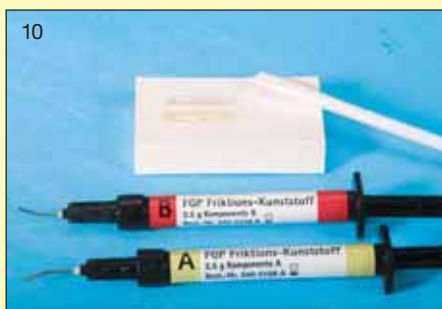
10 Komponenty tworzywa FGP wymieszane w proporcji 1:1.
