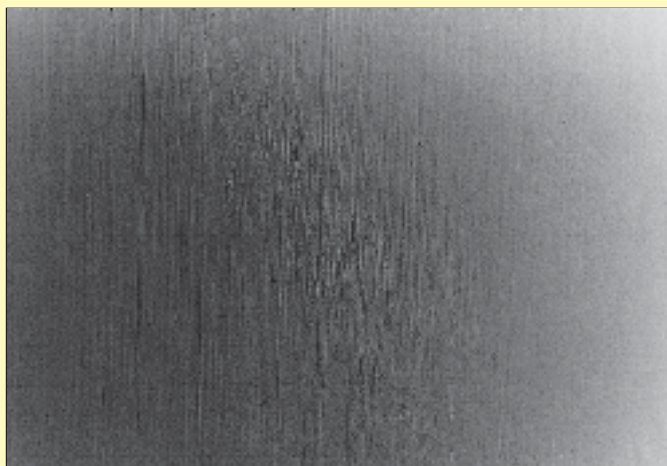
Kontrola pod mikroskopem elektronowym - wewnętrzna powierzchnia korony z FGP, w 100 krotnym powiększeniu.
