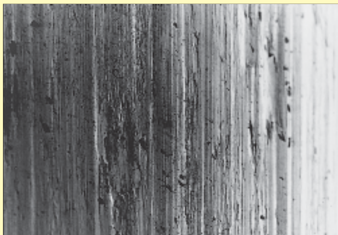
Kontrola pod mikroskopem elektronowym - wewnętrzna powierzchnia korony ze stopu złota, w 100 krotnym powiększeniu.
